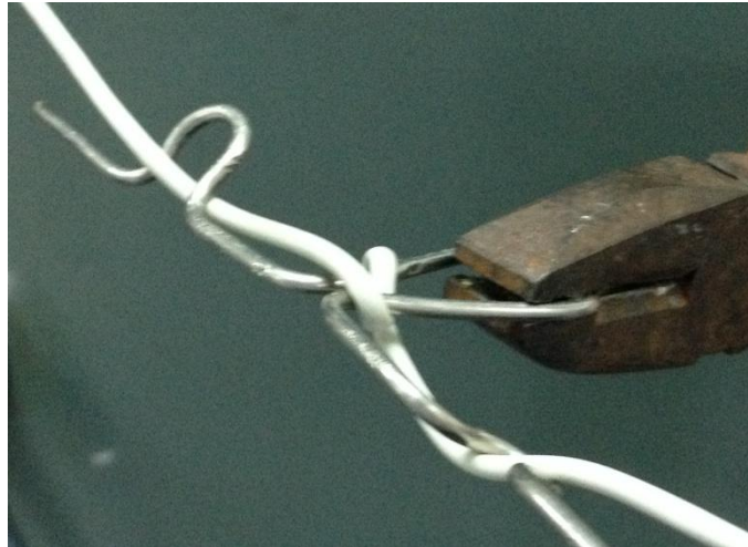
Rajah 7: Kaedah Mengunci Wayar di Wire Tensioner
