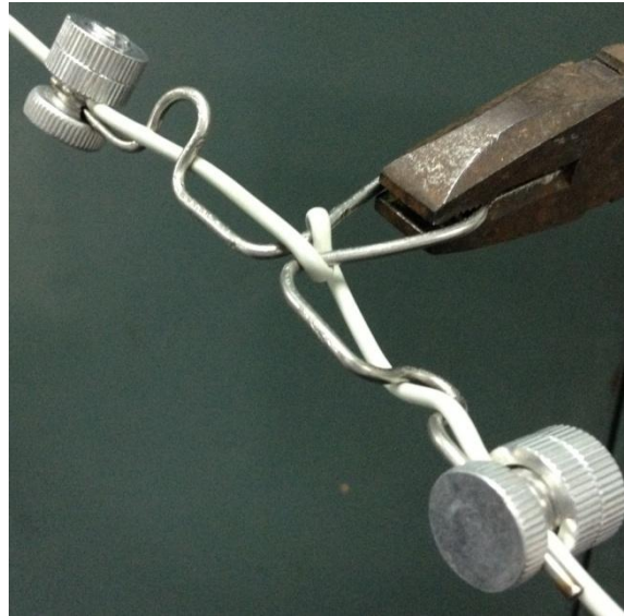
Rajah 9: Split Bolt Kedua Diikat dengan Nut Supaya Wayar Tidak Terurai Daripada Tensioner
