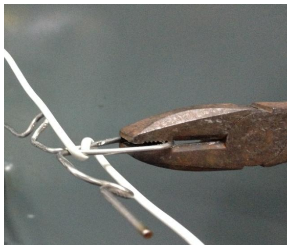
Rajah 6: Wire Tensioner Dipusing Secara Arah Jam atau Arah Lawan Jam
