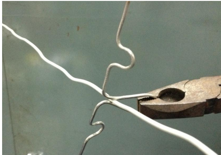
Rajah 5: Cara Memasukkan Wayar pada Ruang Tengah Wire Tensioner
