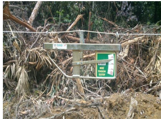
Rajah 18: Penggunaan Wire Tensioner Dapat Menegangkan Wayar Sehingga 50 kg - 80 kg.
